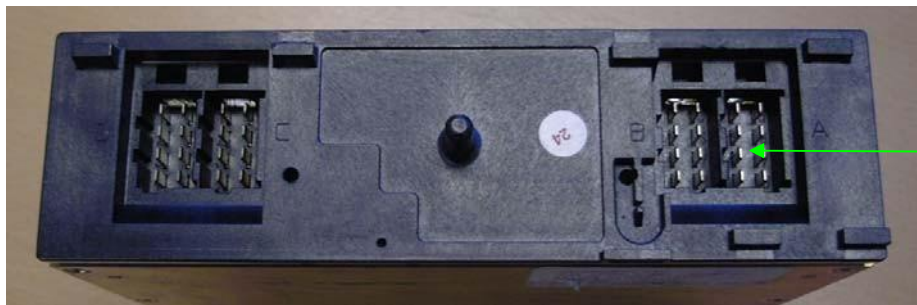
Slika 6 2400 Zadnji priključci i zaptivni poklopac
