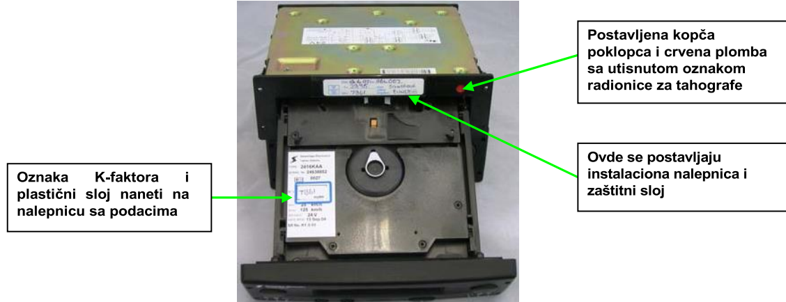
Slika 9 Montažna nalepnica i pozicioniranje na 2400 tahografu
