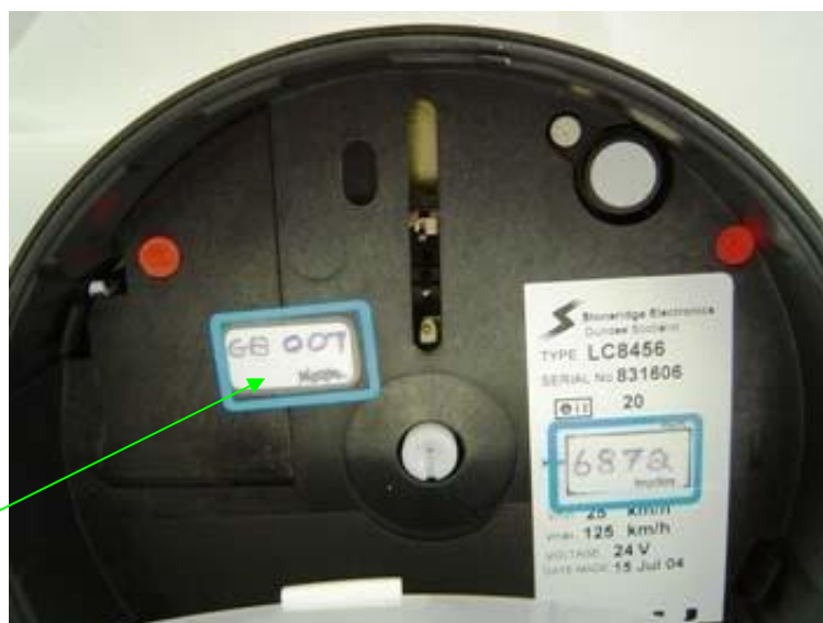
Slika 3 Plombiranje poklopca prekidača za kalibraciju
