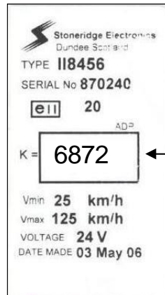
Slika 4 – Uzorak 8400 nalepnice sa podacima na tahografu
